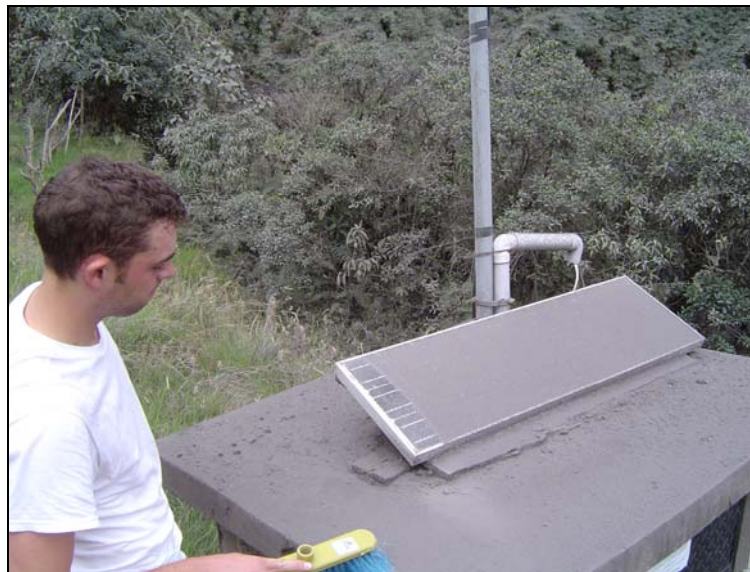
Fotografía 1: Carga de ceniza encontrada sobre el panel solar de la estación de AFM de Vascún (Fotografía por DR)
