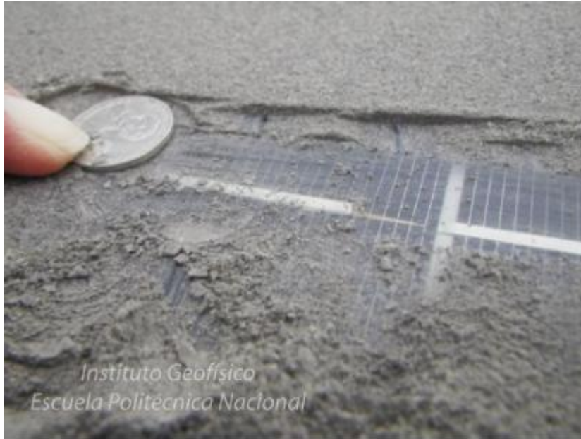
Fotografías: Depósito de ceniza de aproximadamente 3 mm de espesor sobre vegetación y panel solar en la zona de Bilbao, acumulado en 12 horas el día 24 de abril de 2011
