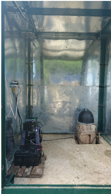
Fig: Nuevas estaciones sísmicas de banda ancha en Alamor ( Prov de Loja), Jipijapa (Prov Manabí) y Volcán Tungurahua
