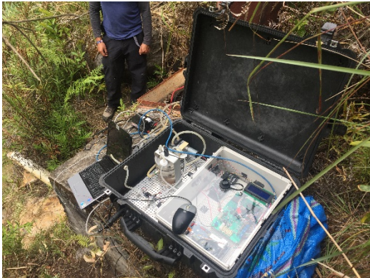
Fig: Medidor de CO2 terminado y esquema del funcionamiento
