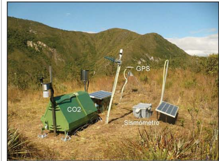
Figura 4: Estación multiparámetros de monitoreo permanente: sismómetro, GPS, espectrómetro de CO2 y estación meteorológica. La estación se encuentra sobre el domo norte de la Isla Yerovi. (Foto: G. Ruiz, IG-EPN)
